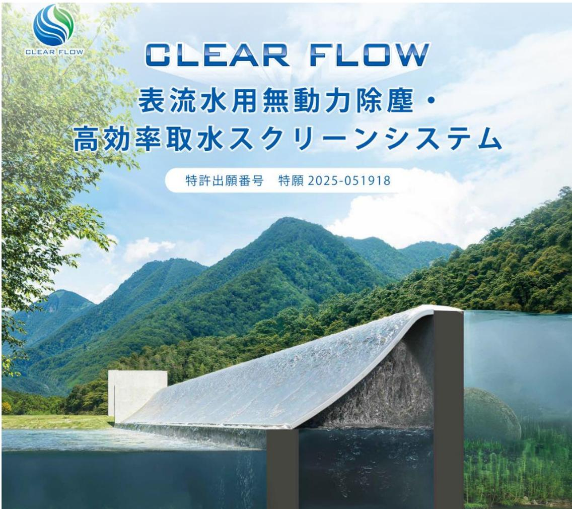
「CLEAR FLOW」は川やダム堰に設置し、石・砂・落葉・木の枝などの異物を、電力を使わず水の力だけで除去を行ながら、高効率な取水が可能なシステムです。頑丈なステンレス製の細かな網目状のパネルを通じて細かい砂や石も除去しながら、河川幅 10m の表流水を最大 93%まで取水が可能です。
