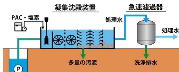
薬品処理のメリットとして、一度に大量の水を処理し、水を作ることができる点が挙げられます。特に、都市化し人口が増加した地域への給水においては無くてはならないシステムです。一方、薬品処理のための広大なスペース、薬品を含んだ汚泥の処理、薬品とその管理などが求められます。
